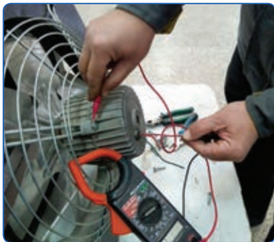
شکل ۱۹- اندازه گیری مقاومت اهمی موتور یونیت هیتر
