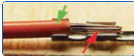
شکل ۱۱- جازدن سر سیم در سیم افشان
